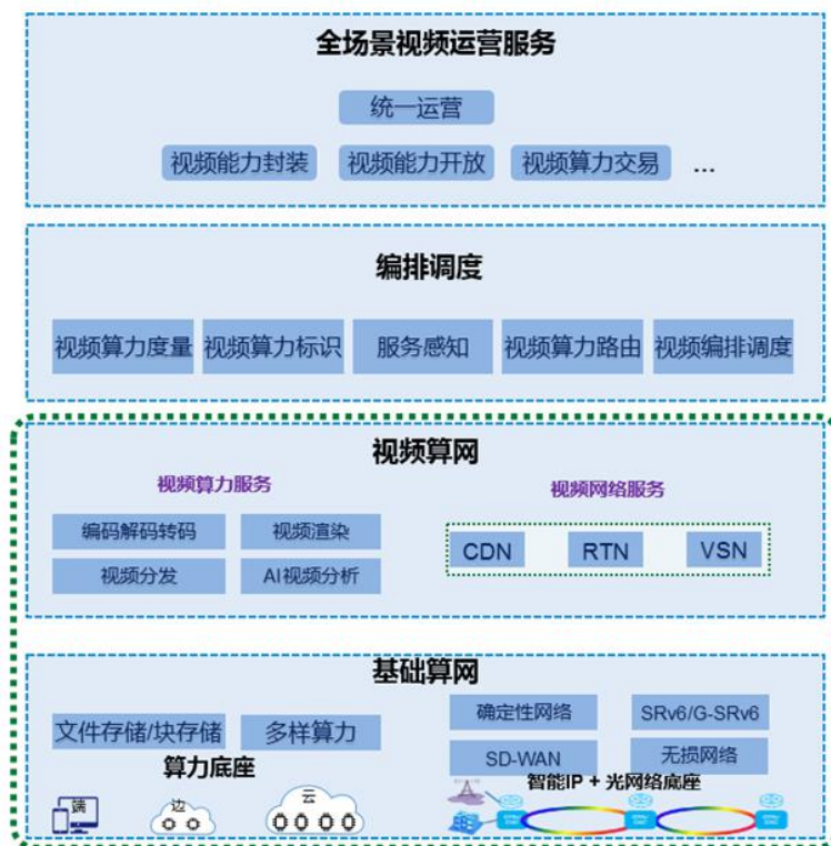
图 9 面向视频业务的算力网络架构
