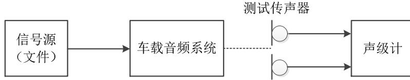
图 2 声性能测试框图
