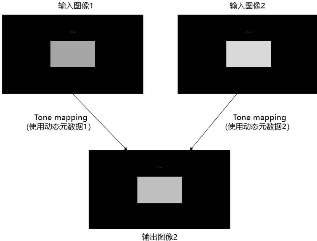
图8 元数据同步性测试示意图
