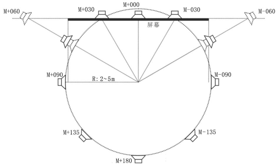
图15 视距0.8H时球形扬声器布局建议
