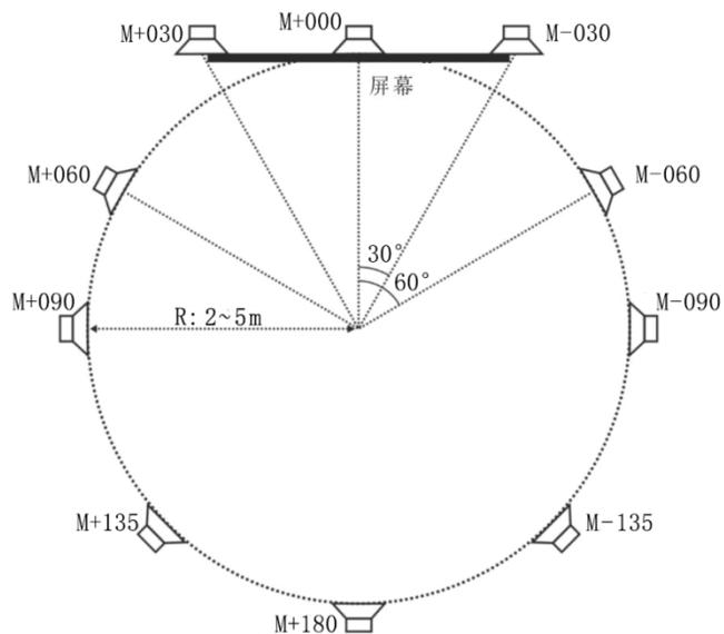
图10 视距1.6H时球形扬声器布局建议
