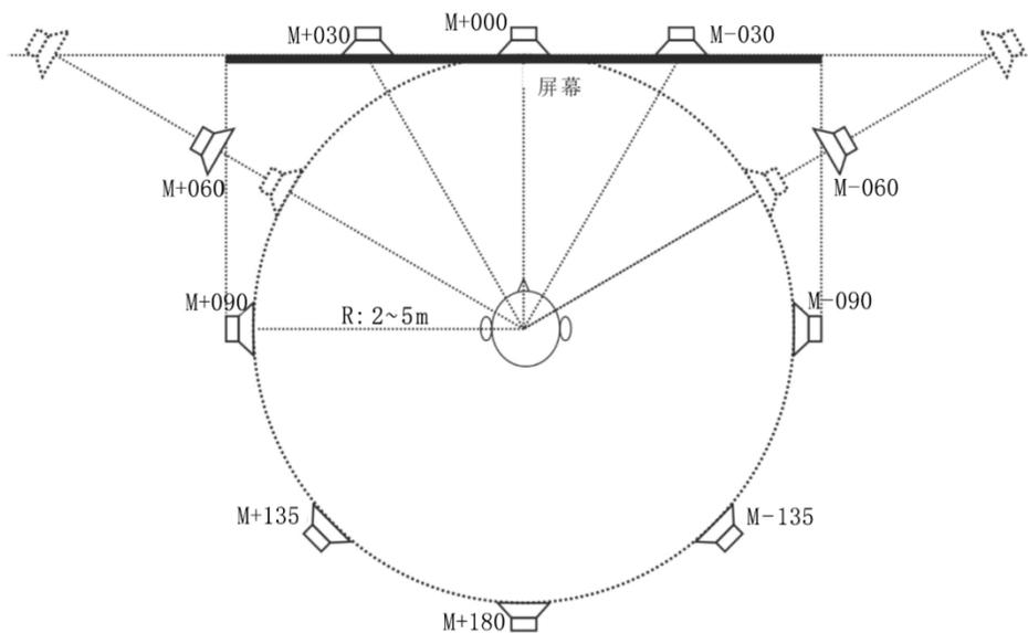
图11 视距0.8H时球形扬声器布局建议
