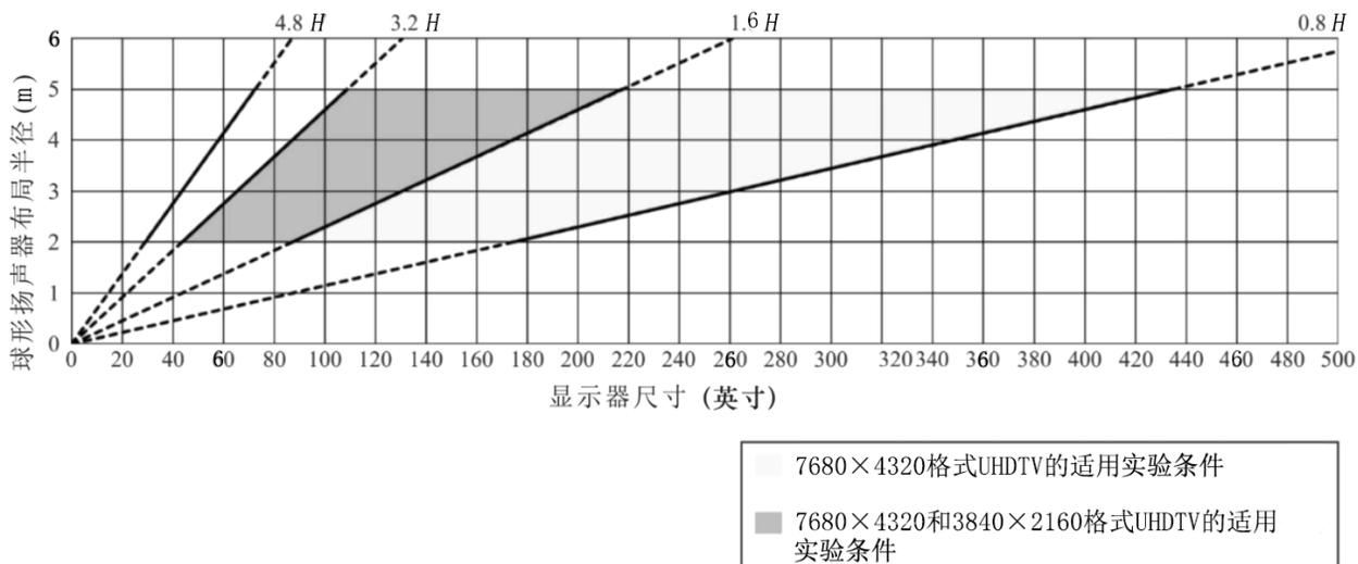
图12 球形扬声器布局半径与视频显示屏尺寸的关系 (与M+030和M-030扬声器对齐)
