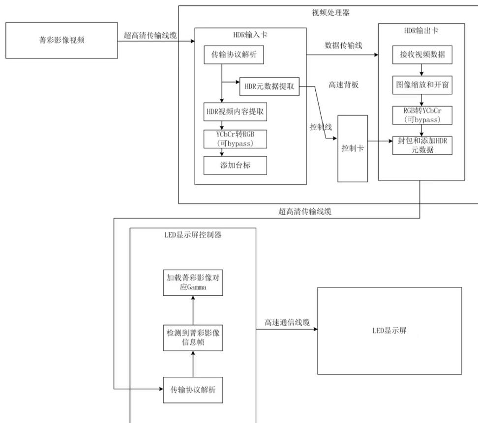
图17 Micro LED处理菁彩影像（HDR Vivid）信号的方式
