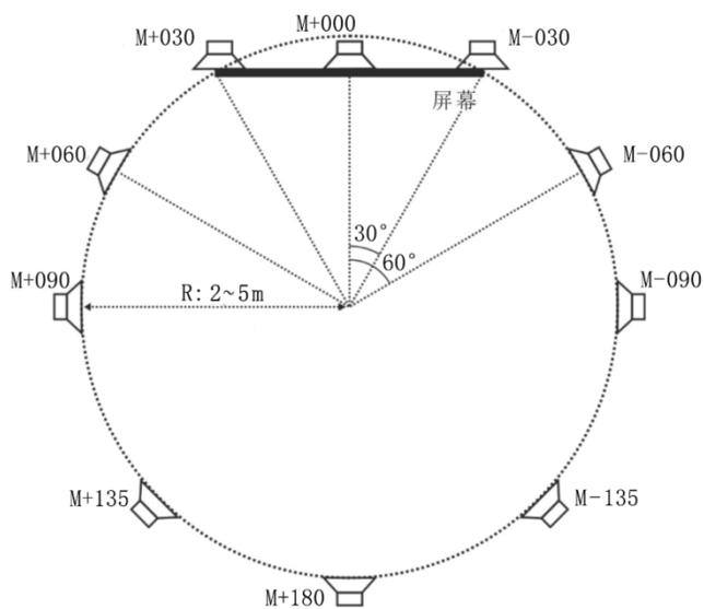
图14 视距1.6H时球形扬声器布局建议
