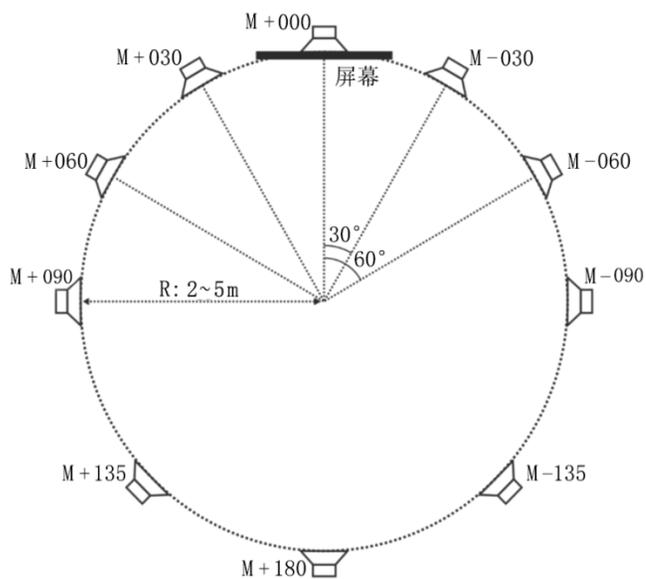
图9 视距3.2H时球形扬声器布局建议
