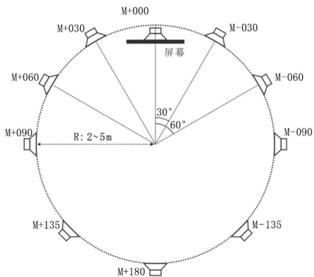
图13 视距3.2H时球形扬声器布局建议
