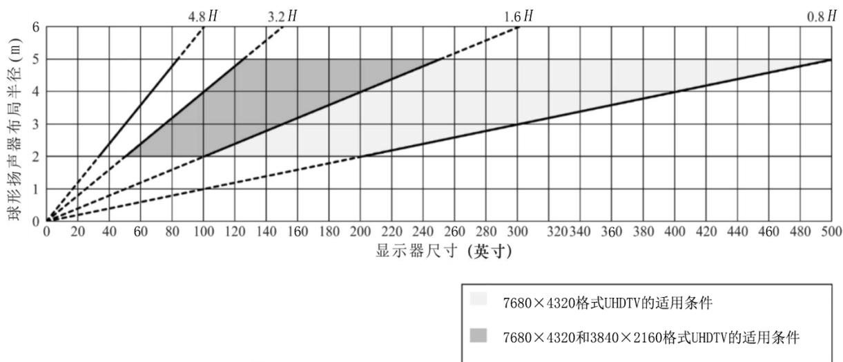
图8 球形扬声器布局半径与视频显示屏尺寸的关系 (与M+000扬声器对齐)
