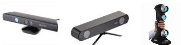
图 3-3 RGBD 相机（Kinect），双目相机（ZED）以及三维激光扫描仪
